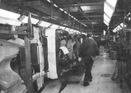
물포의 팀워크 시스템. 차체가 90° 회전할 수 있게 되어 조립작업을 돕는다.
